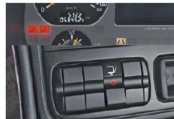
Lkw mit elektrischer Vorrüstung nach ETMA mit vorinstallierter Anzeigeleuchte im Fahrerhaus.
